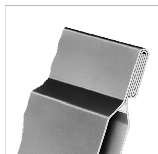
Bild E3: Durch Doppelfalze ergibt sich an den Eintritts- und Austrittskanten eine mehrfache Materialdicke
